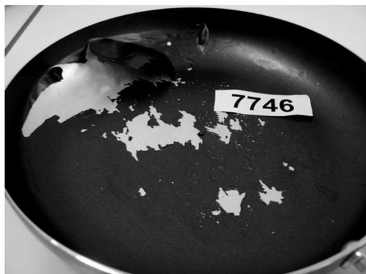
Abb. B-9: Pfanne mit abgelöster Antihafbeschichtung
