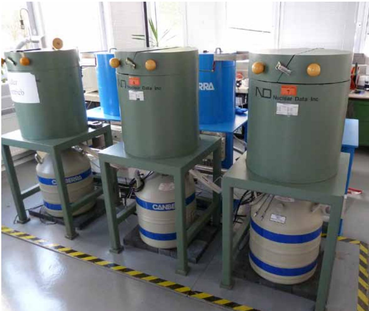
Die Messung der Radioaktivität erfolgt mit  $\gamma$ -Spektrometern, bestehend aus Germaniumdetektor, Hochspannungsteil, Vorverstärker, Verstärker, VKA-Einheit sowie PCs als Steuerungs- und Auswertungseinheiten.
